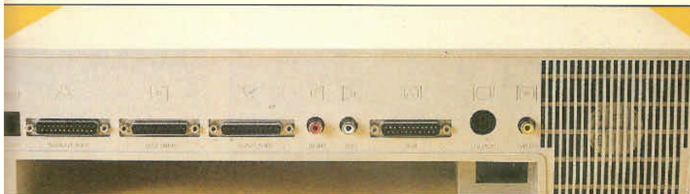
La tastiera dell'Amiga. Sotto il retro della macchina con, da sinistra a destra, le connessioni per: tastiera, stampante, disk drive, seriale, audio stereo, RGB, modulatore, video.
