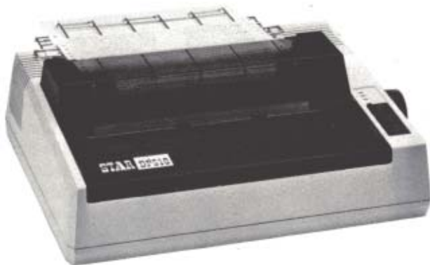
STAR DP 510: Importateur: Hengstler ■ Modèle: Star DP 510 ■ Prix: 4 100 F ■ Interface: Parallèle ■ Type: Matricielle ■ Entraînement: Traction ■ Vitesse: 100 cps ■ Largeur: 132 caractères/ligne en 25,4 cm.
