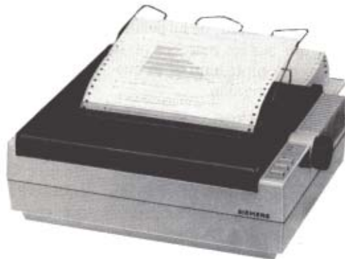
SIEMENS PT 88/ PT 89: Constructeur: Siemens ■ Importateur: Siemens ■ Modèle: PT 88, PT 89 ■ Prix: 8 000 F ■ Interface: Série (RS 232), parallèle, TTY 20 ma, IEEE488 ■ Type: Jet d'encre ■ Entraînement: Mixte ■ Vitesse: 80 ou 150 cps ■ Largeur: 136 caractères/ligne.
